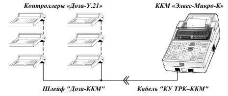
Кабель "КУ ТРК – ККМ" входит в комплект поставки кассового аппарата. На передней боковине ККМ находятся два разъёма для подключения внешних устройств. Вилка 6Р4С кабеля подключается к левому (если смотреть со стороны боковины) разъёму. Вилка 9-ріп соединяется со шлейфом подключения контроллеров "Доза".
