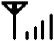
**Есть сигнал.** Значок отображает подключение к сети оператора и уровень сигнала. Подключение к сети оператора прошло успешно, однако невозможно открыть GPRS соединение вследствие каких-либо причин.
