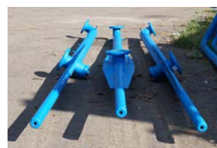
Направляющая стрела стоя- ка налива нефтепродуктов
