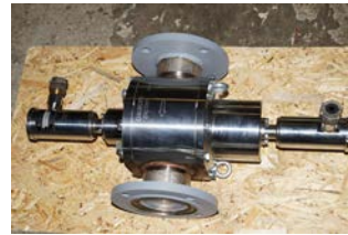
Клапан двухпозиционный с подогревом
