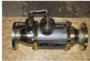
Клапан однопозиционный с подогревом
